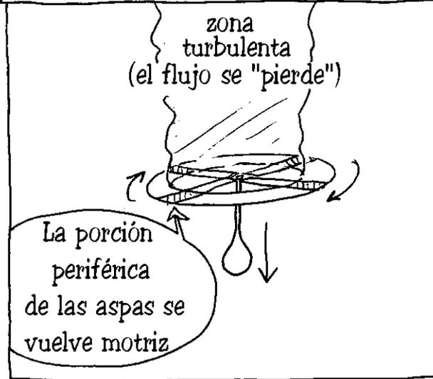
La zona de flujo turbulento (por "arrastre") se reduce a medida que la rotación se vuelve más y más rápida. Aparece entonces en el extremo del aspa una zona "de arrastre"
